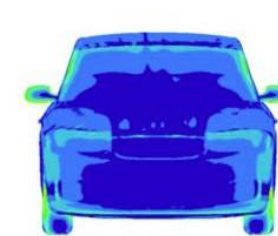
聚类 4: 挡风玻璃中度抬高，存在 3-4 个热点
